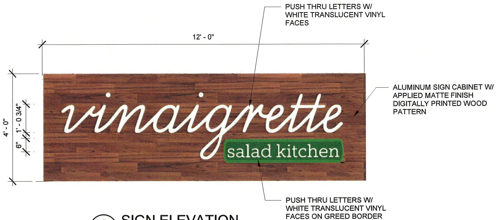
1 SIGN ELEVATION A-700 SCALE: 1/2" = 1'-0"
